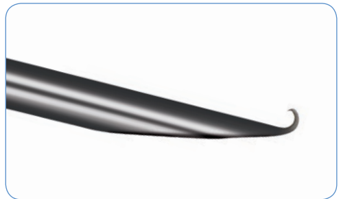
Abb. 5b: Nadel nach mehrfachem Gebrauch mit Häkchen
